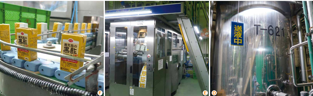
株式会社ふくれんの製造工場では、調合タンクで原材料を調合し(写真D)、異物除去、殺菌を経て充填機で充填し(E)、充填機から出てきた商品(F) に賞味期限を印字し、ストローを付けて箱詰めして出荷します。
