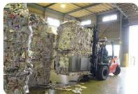
効率よく運搬・リサイクルできるよう、専用の機械で種類ごとに大きな束にまとめます。商品カタログの束は一つ約1.1トン！
