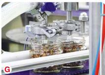
工具の上から大豆油を入れ(写真G)、瓶の口に付着した工具や油を手作業で拭き取ります。金属異物検査などを経て瓶にふたを取り付け(H)、洗瓶機で瓶ごと洗って周りの工具や油を流します(I)。
