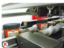
釜に入れ、96度で45分加熱(写真J)。真空状態で加熱することで、風味・色・食感を損なうことなく、中心部まで十分に殺菌します。加熱後は、急激な温度変化で瓶が割れないよう釜の中で20分ほどかけて常温に戻し、釜から出して瓶を乾かします。賞味期限の印字・重量検査を経て包装(K)。官能検査などの品質チェックを行った上で、箱詰めして出荷します(L)。
